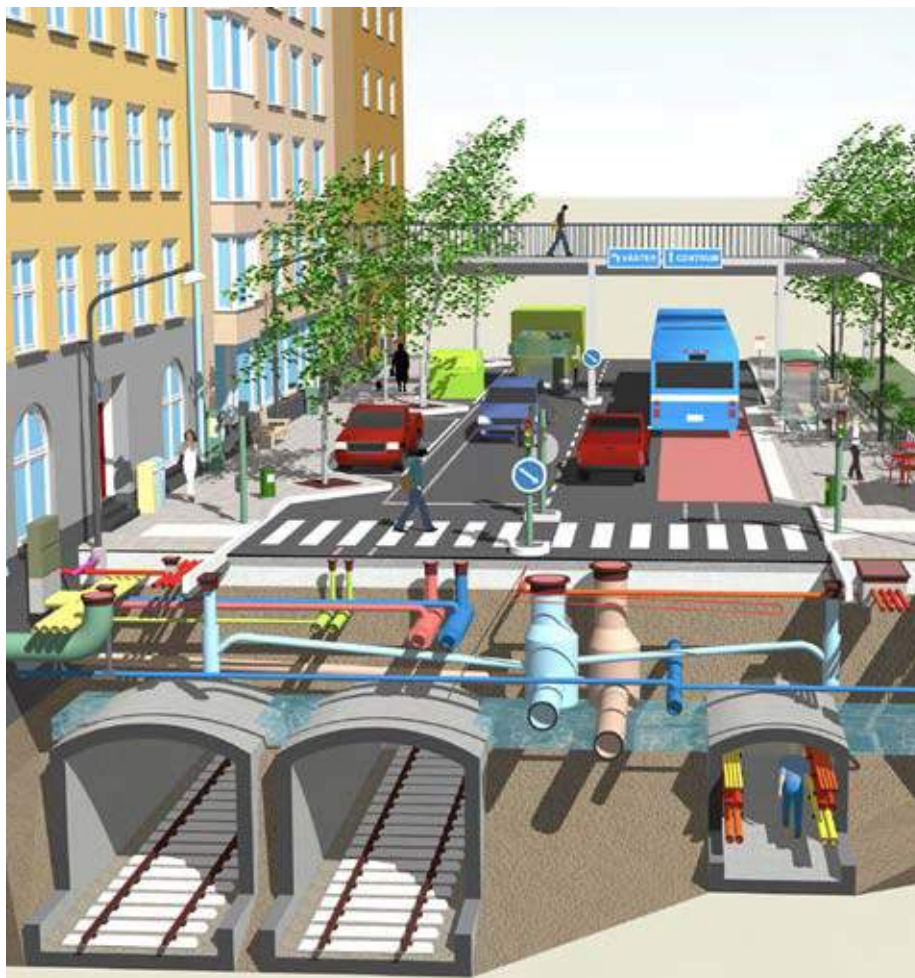
Bilden illustrerar utrymmet i mark i en urban situation. Den växttillgängliga volymen för trädrötter är ofta mycket begränsad pga installationer under mark. (Illustration: Per Magnus, Trafikkontoret, Stockholm)
