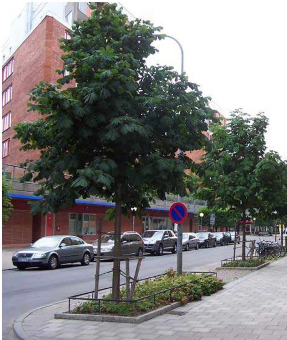
Nyanlagd gångbana med gatuträd i Stockholm. Träden har en underplantering av flocknävor. 15 m 3 skeletjord/ träd och luftigt bärlager är lagd under den hårdgjorda beläggningen. Dagvatten från hustaken leds via skålformade betongrännor till luftnings- och dagvattenbrunnar. (Foto: Björn Embrén)
