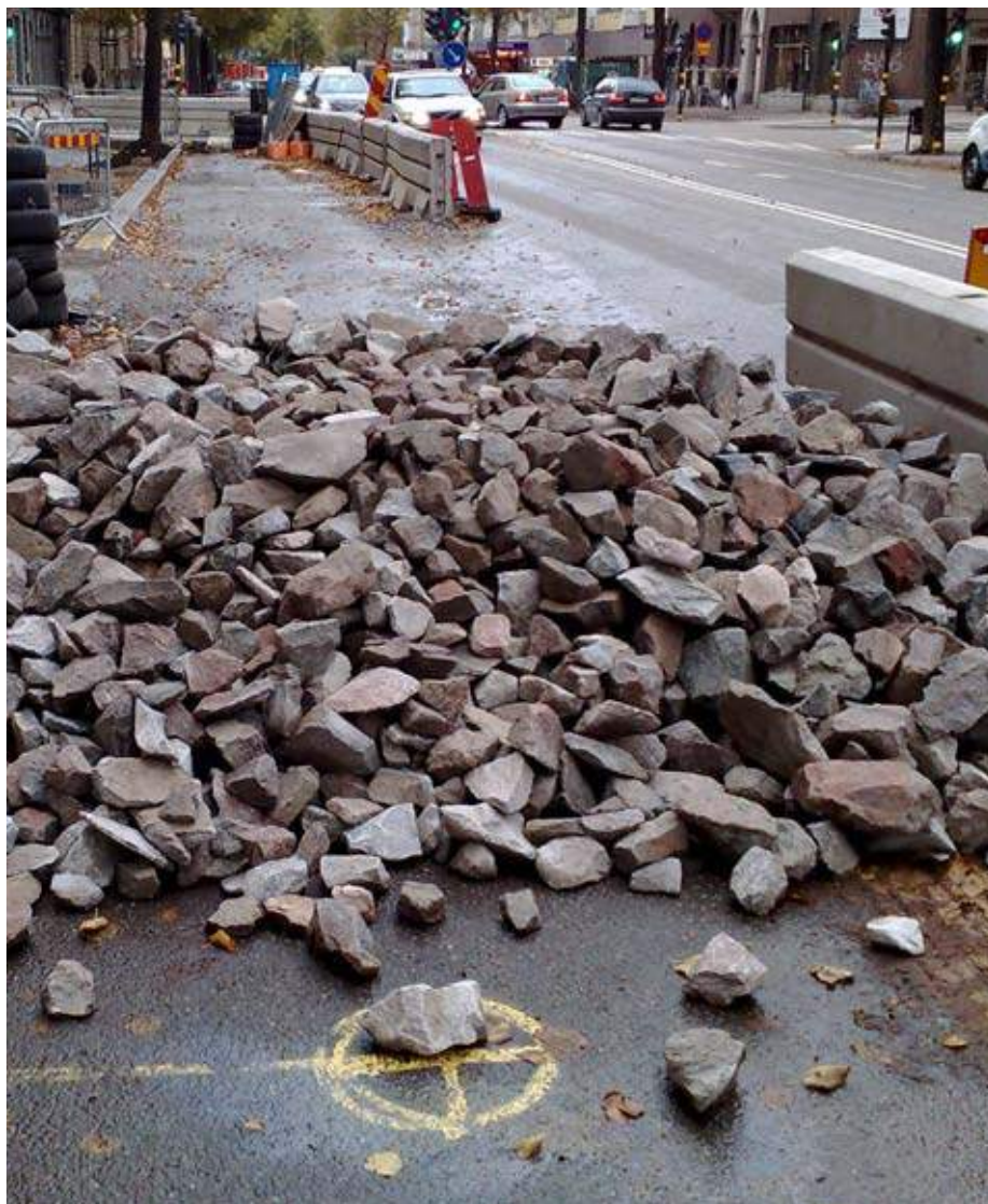
Skelettmaterial, makadam 100-150 mm, för skelettjord. (Foto: Örjan Stål)
